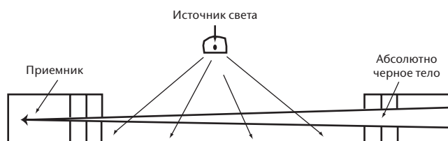
Рисунок 9.6. Измеритель видимости, основанный на измерении рассеянного света в широком угле.
